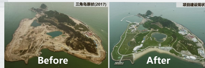
岸线修复: 沙滩岸线修复630m, 修复沙滩4.14万㎡, 垒石砾石岸线修复约2000m 湖泊整治: 湖泊整治岸线900m 绿化工程: 边坡复绿5万㎡, 裸地复绿20万㎡。
