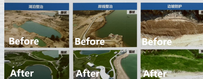
岸线修复: 沙滩岸线修复630m, 修复沙滩4.14万㎡, 垒石砾石岸线修复约2000m 湖泊整治: 湖泊整治岸线900m 绿化工程: 边坡复绿5万㎡, 裸地复绿20万㎡。
