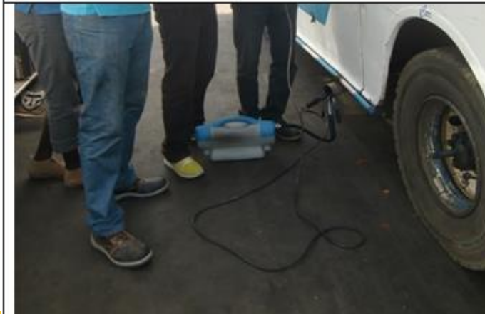
Image 1 : Analyse de fumées à partir du pot d'échappement d'un bus « Tata »
