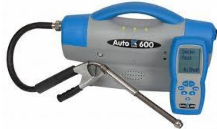
Image 1 : Analyse de fumées à partir du pot d'échappement d'un bus « Tata »
