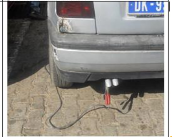
Image 2 : Analyse de fumées à partir du pot d'échappement d'un véhicule particulier au CCTVA
